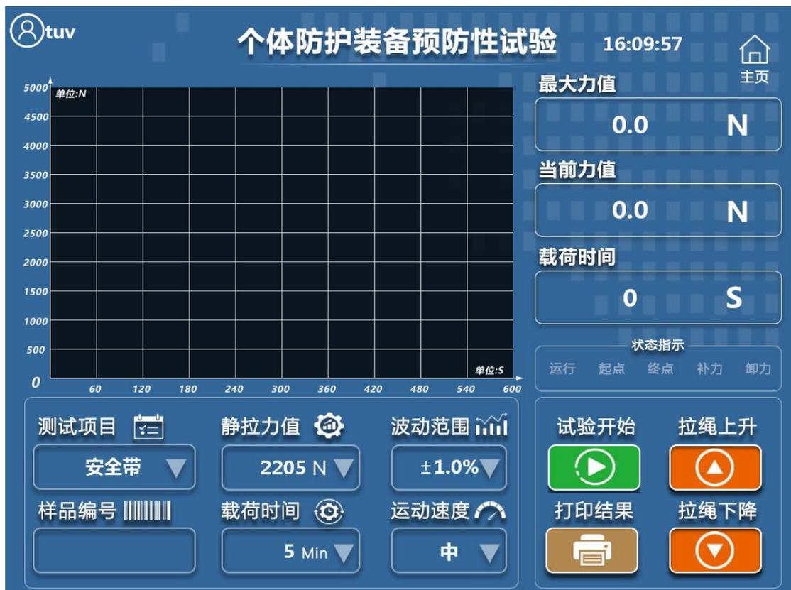
(2) 选择待测试项目并设定参数，根据标准要求，静拉力值会自动弹出对应的“静拉力值”与“载何时间”（注：在选择其它时，力值可自定义）；根据实际需要，选择波动范围值；输入样品编号以及运动速度。
